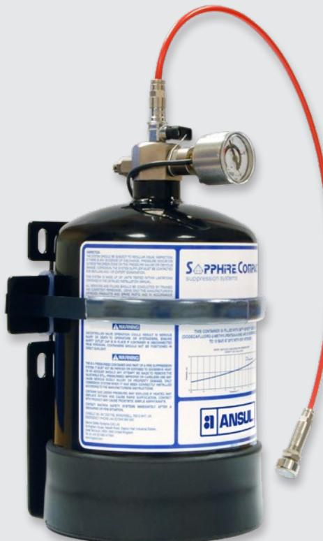
**Le tube de détection placé à travers les zones à haut risque de l'enceinte, assure une détection rapide et efficace.** Lors d'un impact de flamme ou d'une température ambiante élevée, le tube de détection sous pression se rompt au point le plus chaud. L'agent extincteur se décharge ensuite par le trou d'éclatement au cœur du feu.
